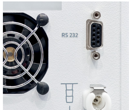
标配的 RS 232 通信模块方便集成到工艺系统中
